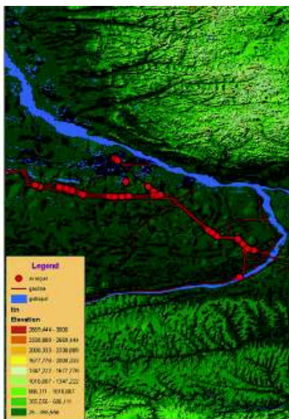
Рис. 1. Распределение отказов и аварий газопровода Мастаах-Берге-Якутск
