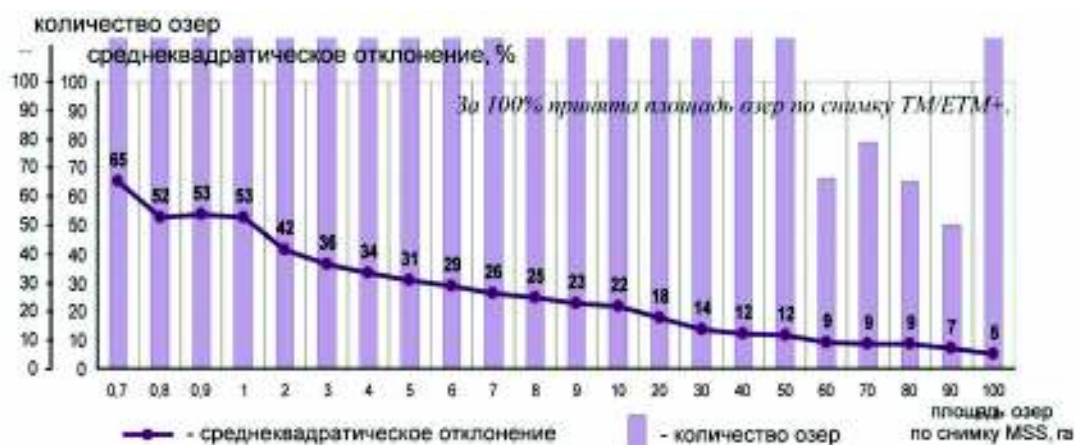
Рис. 2. Среднеквадратические отклонения площадей озера разного размера, полученных по одновременным снимкам со спутника Landsat разного разрешения
