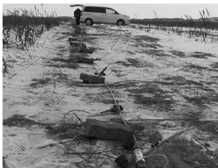
Рис. 8.78. Горизонтальный сейсмоприемник GS-20DX. Производство ООО «OYO-GEO Impulse International», г. Уфа (А) и способ их установки на профиле (Б)
