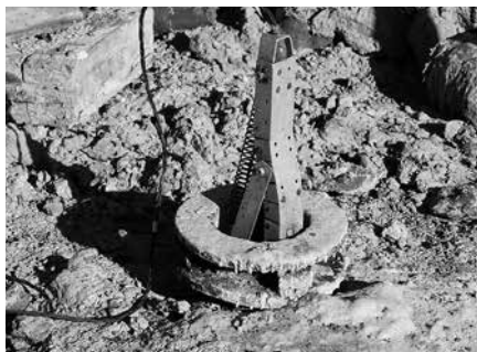
Рис. 8.80. Скважинный трехкомпонентный сейсмический зонд. А — зонд в открытом состоянии, Б — зонд в устье скважины
