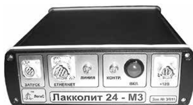
Рис. 8.79. Телеметрическая сейсмическая станция «ТЕЛЛС-3» (ООО «Геосигнал», Россия) (А) и регистратор сейсмостанции «Лакколит 24-М3» (ООО «ЛогиС», Россия) (Б)
