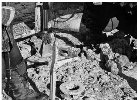
Рис. 8.80. Скважинный трехкомпонентный сейсмический зонд. А — зонд в открытом состоянии, Б — зонд в устье скважины
