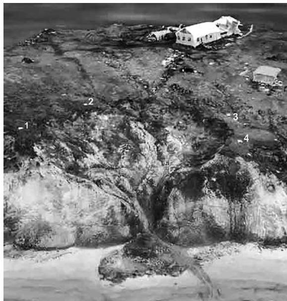
Рис. 8.47. 3D-модель термоденудационного цирка (ТДЦ) рядом с помещением дизельной. Цифрами обозначены маркеры и их номера
