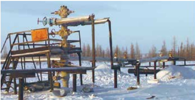
Рис. 4.14. Деформации трубопроводов устьевой обвязки скважины (А) и результаты моделирования напряженно-деформированного состояния трубопроводов (Б). Красным цветом выделены сверхнормативно нагруженные участки
