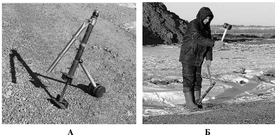
Рис. 8.77. Источник сейсмических колебаний. А — источник сейсмических колебаний, Б — процесс возбуждения колебаний
