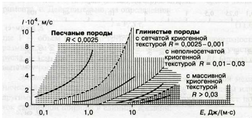
Рис. 11.5. Обобщенные зависимости интенсивности размыва оттаивающих пород от энергии водного потока
