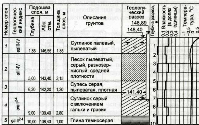
Рис. 6.25. Образец графического оформления инженерно-геологического разреза
