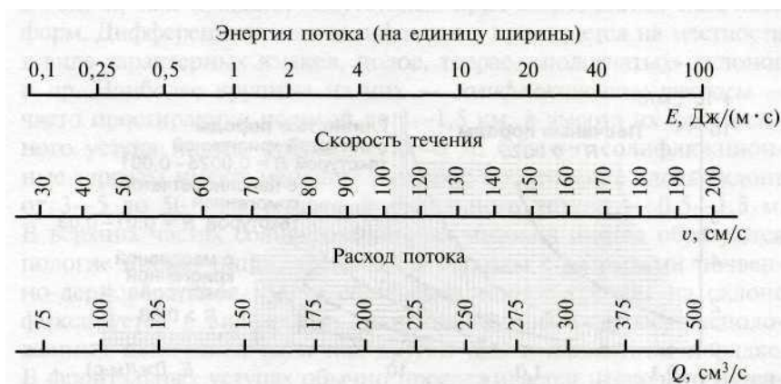
Рис. 11.4. Соотношение скорости расхода и энергии водного потока в щелевом лотке шириной 2,5 см при глубине слоя воды 1 см
