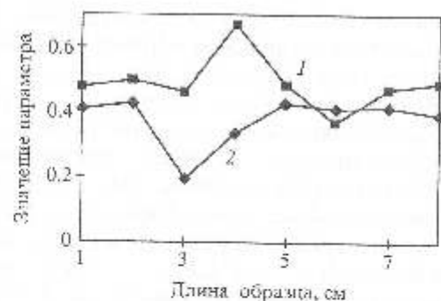
Рис. 39. Распределение засоленности (в % — кривая 1) и влажности (д.с. — кривая 2) в мерзлом морском суглинке при воздействии температурного градиента (слева — 2,2^{\circ}\text{C} , справа — 2,7^{\circ}\text{C} ) после четырех лет экранирования
