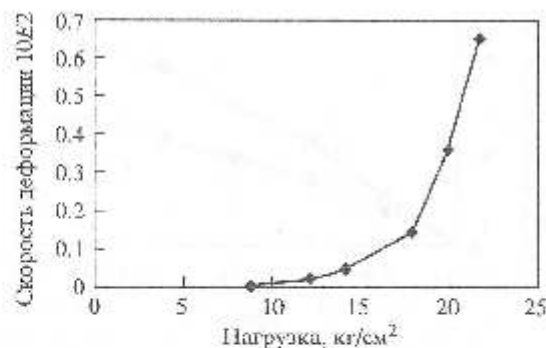
Рис. 78. Реологическая кривая, построенная по скоростям установившейся ползучести мерзлого засоленного песка (р. Еркута-Яха) при одностороннем сжатии при t = -3^\circ\text{C} , D_{\text{sat}} = 0.05\% , W = 26\%
