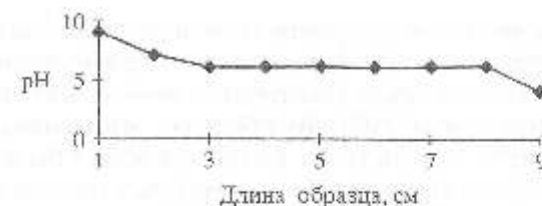
Рис. 53. Распределение подпорного показателя рН в образце мерзлого суглинка с начальной влажностью 0,46 и засоленностью 1,0% при пропускании постоянного электрического тока (катод слева) и U = 9,6 В, I = 0,4 мА, при температуре -2,5 °С после 12 суток эксперимента
