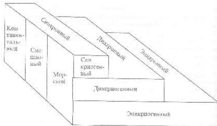
Рис. 13. Классификация мерзлых засоленных пород по типам засоления
