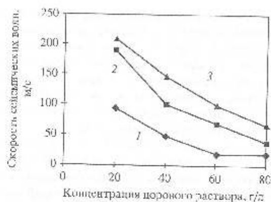
Рис. 51. Зависимость скоростей продольных сейсмических волн в засоленной сулесе от концентрации порового раствора при температуре 5 °C
