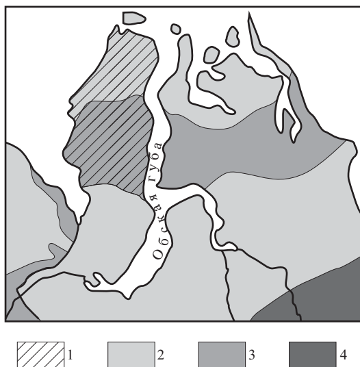
Рис. 10.11. Схема распространения солифлюкции на севере Западно-Сибирской плиты, области: 1 – быстрой солифлюкции (оплывины, ложбины) в местах развития термоэрозии на склонах крутизной более 15\text{--}20^\circ ; 2 – медленной солифлюкции (солифлюкционные террасы, потоки, валы, гряды, покровы) на склонах крутизной 3\text{--}40^\circ ; 3 – умеренного проявления медленной солифлюкции (солифлюкционные террасы, валы, гряды, покровы) на склонах крутизной 5\text{--}20^\circ ; 4 – слабого развития солифлюкции
