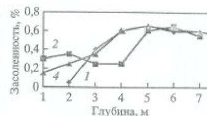
Рис. 19. Распределение засоленности в разрезе 3 морской террасы, сложенной суглинками в п. Амдерма по трем скважинам (обозначены цифрами)
