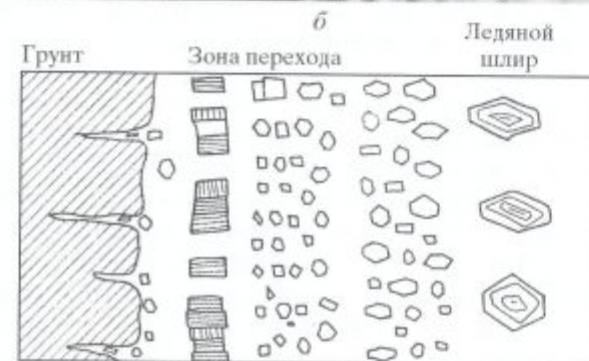
Рис. 49. Строение зоны контакта ледяной шлир (горизонтального простирания) - минеральный прослоек: а - фото; б - схема [46]
