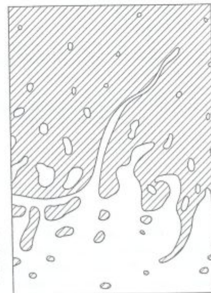
Рис. 51. Соотношение площадей мерзлых толщ и таликов в южной части области распространения мерзлых пород. Мерзлые толщи заштрихованы [62]
