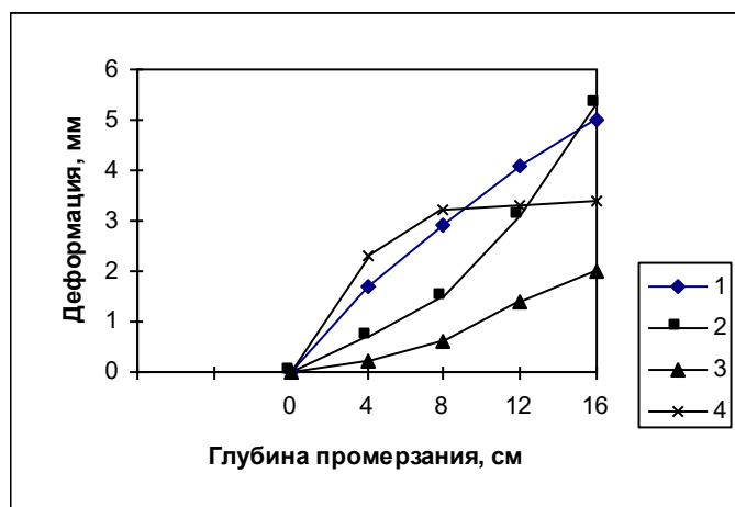
Рис. 22. Развитие напряжений (а) и напряжений (б) пучения по мере промерзания образца при -2^{\circ}\text{C} : 1 - каолинитовая глина; 2 - полиминеральная засоленная глина; 3 - монтмориллонитовая глина; 4 - торф
