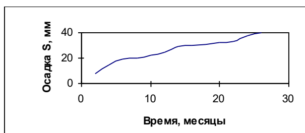
Рис. 115. Суммарная осадка (S) здания жилого дома №21 радиометцентра в п.Амдерма (Ю.Я.Велли и др., 1994)
