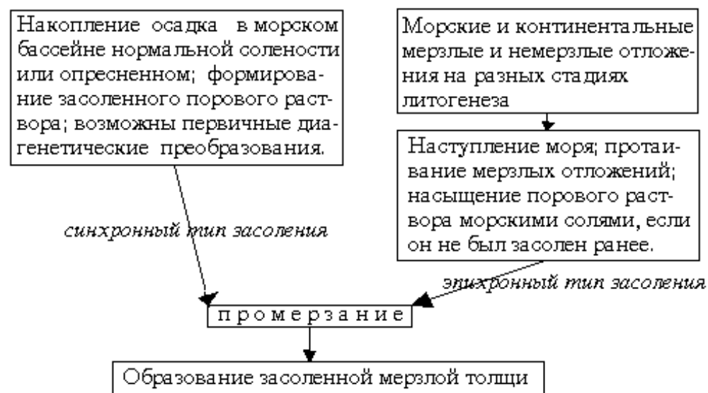
Рис. 1. Основная схема формирования засоленных многолетнемерзлых пород Арктического побережья
