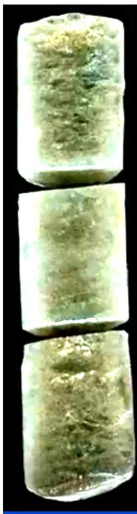
Рис. 1.2. Газонасыщенный лёд из горизонта с аномально высоким содержанием водорода (глубина 16м) в многолетнем бугре пучения на месторождении Песцовое Тазовский п-ов.
