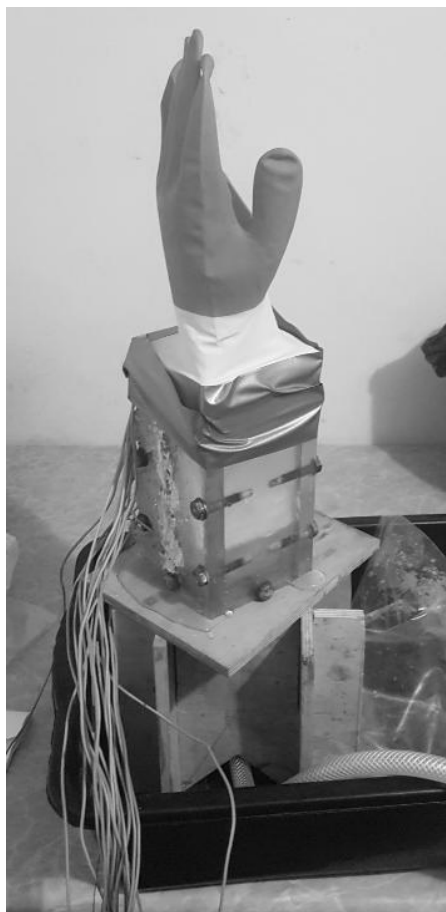
Рис. 3.14. Установка для исследования фильтрации газа в мёрзлых грунтах. Фото П.А. Соболева
