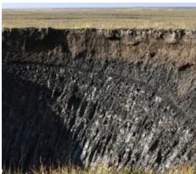
Рис. 4.37. Криогенное строение глинистой толщи в стенке конусообразной части кратера (рис. 4.36.) (сетчатые криотекстуры с преобладанием вертикальных шлиров. Фото К. Hunt. [ https://edition.cnn.com/2020/09/04/world/craters-tundra-siberia-trnd-scni/index.html ]
