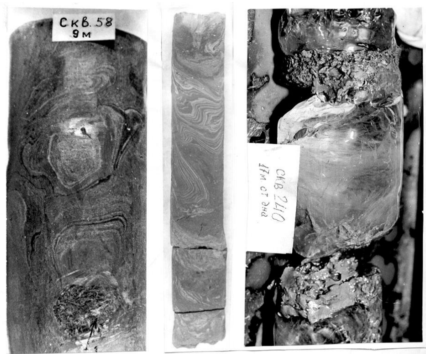
Рис. 2.12. Подземный лед в дислоцированных донных отложениях Баренцево-Карского шельфа по скважинам [Бондарев и др., 2001]
