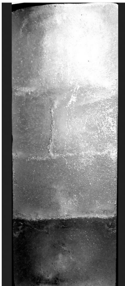
Рис. 3.19. Образца льда приготовленного послойным наливом. Фото П. А. Соболева.
