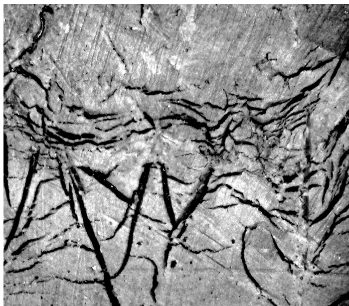
Рис. 3.36. Верхняя часть образца. Вертикальный срез. Слой слоисто-сетчатых криотектур (слой 4) и перекрывающий его слой массивной криотекстуры (слой 5). Фото. П. А. Соболева
