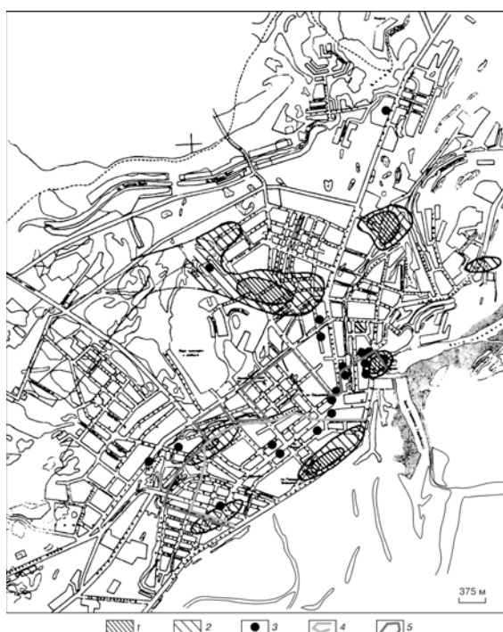
Рис. 11. Карта современной застройки Якутска на 2003 г. с нанесенными областями распространения засоленных грунтов (1,2), зданиями, находящимися в аварийном состоянии (3), и границами исторической городской застройки 1821г. (4) и 1908 г. (5) (Алексеева и др., 2007).
