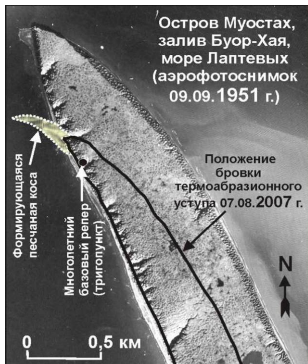
Рис. 5. Отступление береговой линии острова Муостах в море Лаптевых. На фоне аэрофотоснимка 1951 года нанесено положение береговой линии по состоянию на 2007г. Даже визуальный анализ показывает, что остров быстро разрушается, и его, несомненно, ждет участь ряда исчезнувших арктических островов.
