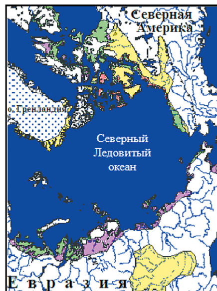
Рис. 28. Схема распространения засоленных многолетнемерзлых грунтов различных типов в Северном полушарии, составленная автором: желтый цвет — континентальное (преимущественно сульфатно-карбонатное) засоление; зеленый — морское (преимущественно хлоридно-натриевое) засоление морских отложений; розовый — смешанное засоление; фиолетовый — морское засоление континентальных и морских отложений
