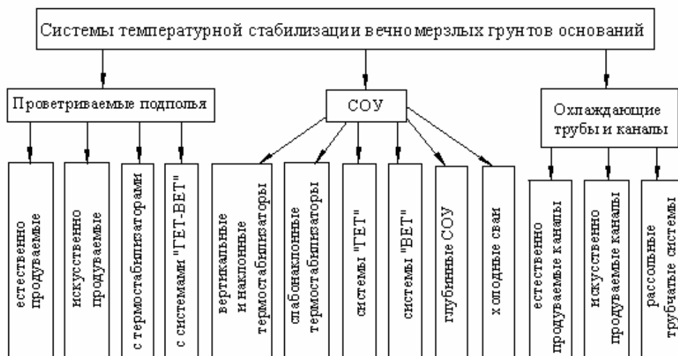
Рис.5. Классификация систем температурной стабилизации вечномерзлых грунтов оснований зданий и сооружений
