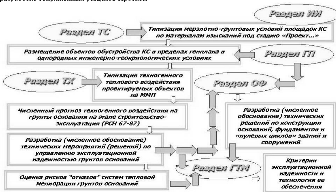
Рис. 3. Принципиальная блок-схема разработки раздела "Термостабилизация грунтов" (ТС) и его "взаимодействия" с сопряженными разделами Проекта - Инженерные изыскания (ИИ), Генеральный план (ГП), Технология производства (ТХ), Основания и фундаменты (ОФ), Геотехнический мониторинг (ГТМ)
