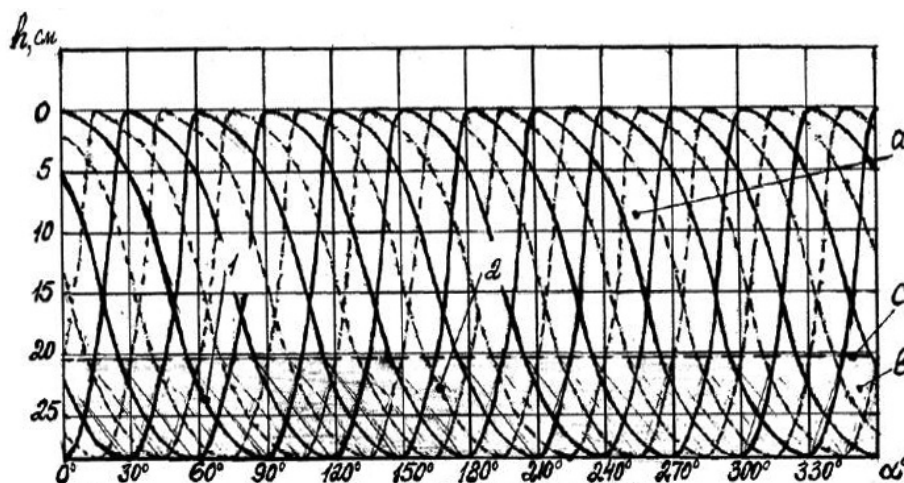
Рис. 4. Схема смещения фаз импульса вдавливания шпор по углу поворота второго барабана относительно первого.
